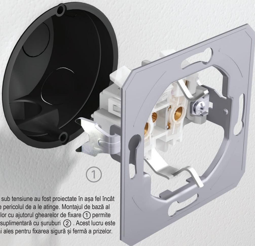
Elementele sub tensiune au fost proiectate în aşa fel încât să nu existe pericolul de a le atinge. Montajul de bază al mecanismelor cu ajutorul ghearelor de fixare ① permite strângerea suplimentară cu șuruburi ②. Acest lucru este adecvat mai ales pentru fixarea sigură și fermă a prizelor.
