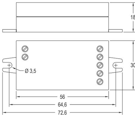
eBLUE MULTI4 es un regulador PWM de cuatro canales controlable por Bluetooth para cargas LED de tensión constante, tales como tiras y módulos LED de tensión constante.
