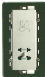
14291.SL 6 230 V~ 50/60 Hz, cu 20 VA transf deizolare, iesire 230 V~ si 120 V~. Adâncime: 41 mm
